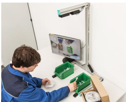
Im Projekt AMBOS-3D haben das Fraunhofer IPA und Partner ein Assistenzsystem entwickelt, das mit optischer 3D-Sensorik die Mitarbeiter in Werkstätten für Menschen mit Behinderungen beim Packprozess unterstützen. (Quelle: Fraunhofer IPA, Foto: Rainer Bez)
